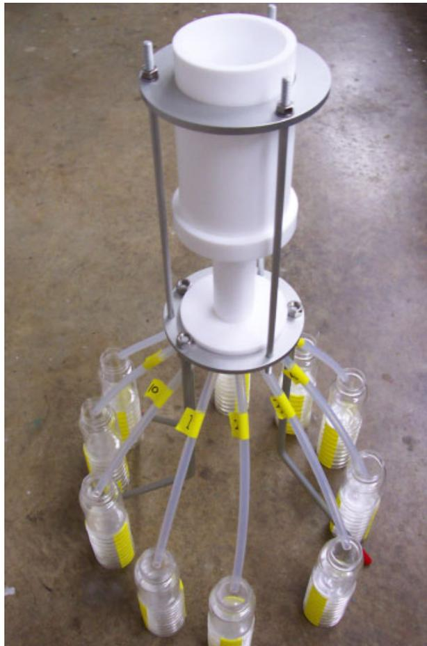
Fig. 30. UAGS/Dekaport Cone Sample Splitter
