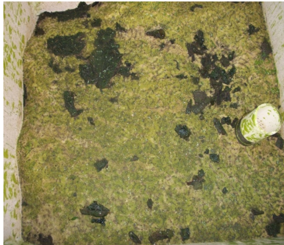
(d) Algae Trapped on Top of the Filter Sand
